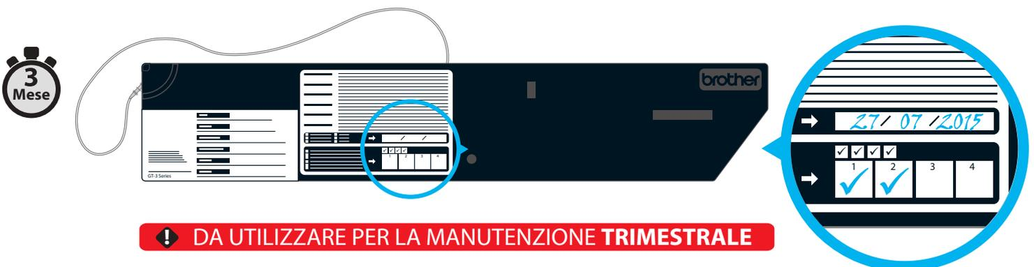
Questa **cartuccia di manutenzione per CMYK** deve essere utilizzata per eseguire il **PTC** ogni **tre mesi**. E' l'unico modo per pulire facilmente tutti i piccoli tubetti di colore all'interno della stazione di manutenzione e mantenere una buona aspirazione della pompa per la pulizia delle testine di stampa.
