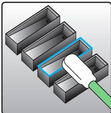
Bagnare un tamponcino come per la pulizia della lama del tergicristallo e tamponare i bordi e l'interno dei tappi di gomma. Utilizzare un lato del tampone per cappuccio per evitare la contaminazione dei colori.
