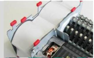
Schede elettroniche altamente affidabili (ricoperte da entrambe i lati). Presenza di trasformatori che assicurano la massima sicurezza (voltaggio di soli 12 volt).
