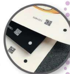
La telecamera Vision3 legge i codici QR in bianco o nero per recuperare immediatamente i file di taglio associati
