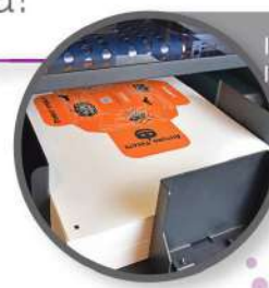
Le lame d'aria anteriori e i bastoncini separatori assistono la separazione dei supporti per alimentare perfettamente ogni foglio
