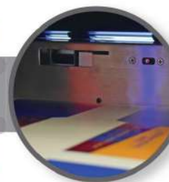
Il nastro aspiratore continuo solleva e alimenta i fogli sul piano di taglio, pronti per essere tagliati
