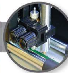
La telecamera Vision3 legge i codici QR in bianco o nero per recuperare immediatamente i file di taglio associati
