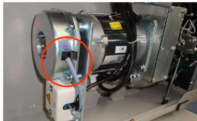
**Sicurezza:** Freno a disco facile da sostituire. **Funzione freno in entrambi i sensi di marcia:** il freno si apre solo durante il funzionamento; una volta consumato non rilascia il taglio.
