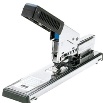
Cucitrice manuale estremamente robusta e affidabile. Struttura metallica. Utilizza punti serie 23. Caratteristiche: leva sgancia punto, finestra per il monitoraggio dei punti residui, possibilità di controllare l'altezza del punto installato, blocco leva per ottimizzare lo spazio quando non utilizzata, selettore profondità con guida per la misura del punto, ribattitore invertibile per punto ribattuto o aperto.
